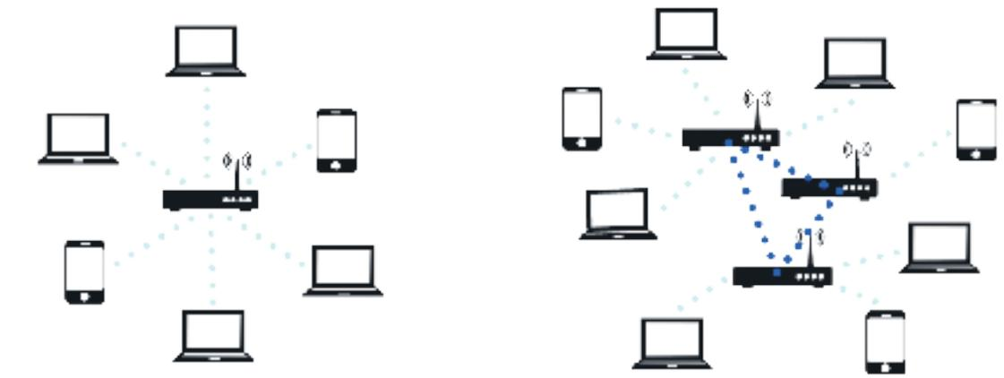
**Funkknotenschema** beim klassischen WLAN (l.) und Mesh-Netz als leistungsfähigere Alternative (r.).
